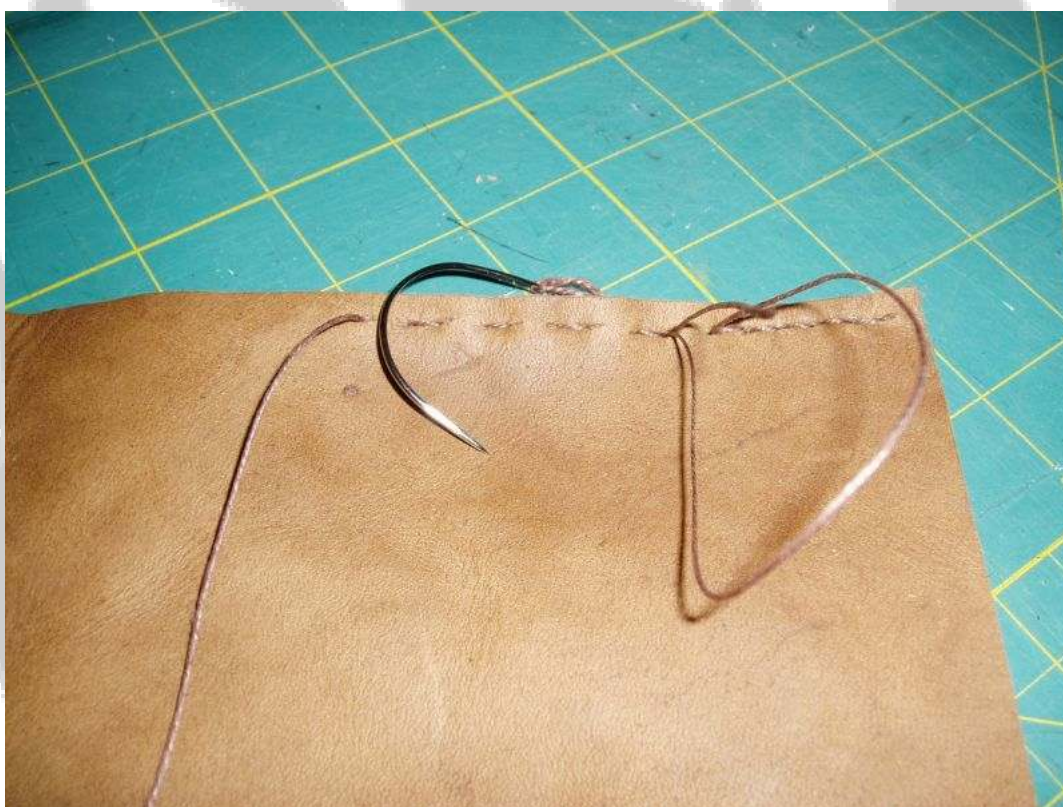
...a připravenými dírami pak šijeme ševcovským stehem oba díly kůže k sobě. Šijeme ševcovskou dratví a jehlou.
